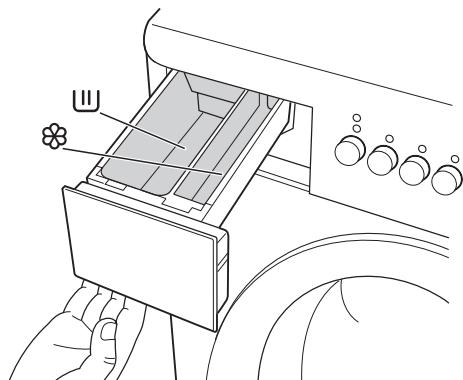
W Отделение для порошкового или жидкого моющего средства, используемого при основной стирке. При использовании жидкого моющего средства наливайте его **непосредственно перед** запуском программы.
