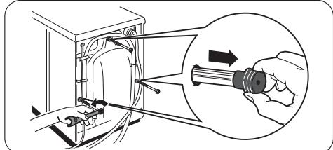
С помощью подходящего гаечного ключа на задней панели машины вывинтите три болта и снимите их вместе с прокладками.
