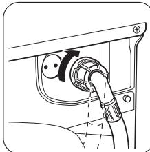
Конец этого шланга со стороны машины можно повернуть в любом направлении. Отрегулируйте положение шланга, ослабив зажимную гайку. Отрегулировав положение шланга, не забудьте плотно затянуть зажимную гайку во избежание утечек.
