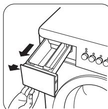
При необходимости очистки дозатор моющих средств может быть извлечен из машины целиком. Для этого необходимо сильно потянуть его наружу, чтобы освободить от стопора.
