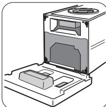
Снимите полистироловое основание и пластиковую опорную раму, на которых лежит машина.
