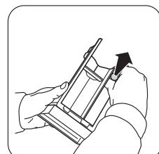
Чтобы снять для чистки сифон, расположенный у внутренней кромки дозатора, необходимо прижать его внутрь и одновременно потянуть вверх. Промойте его под краном, чтобы удалить все остатки скопившегося в нем порошка. При обратной установке дозатора прижмайте его вниз, пока не услышите щелчок.
