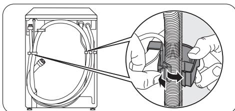
Поставьте машину вертикально и отсоедините сетевой шнур и сливной и наливной шланги от разъемов на задней панели прибора.
