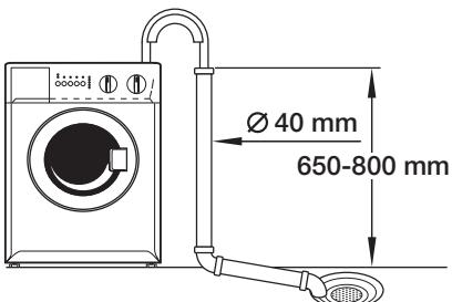
Шланг устанавливается в стояк не глубже, чем на 50 мм и его необходимо зафиксировать в этом положении. Сливной шланг не должен иметь перегибов.
