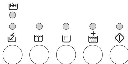
При выборе ошибочной функции соответствующий индикатор мигает в течение примерно 2 секунд. О совместимости различных дополнительных функций с теми или иными программами стирки см. в разделе **"Программы стирки"**.
